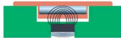
Courbe magnétique normale avec seulement 1 aimant
