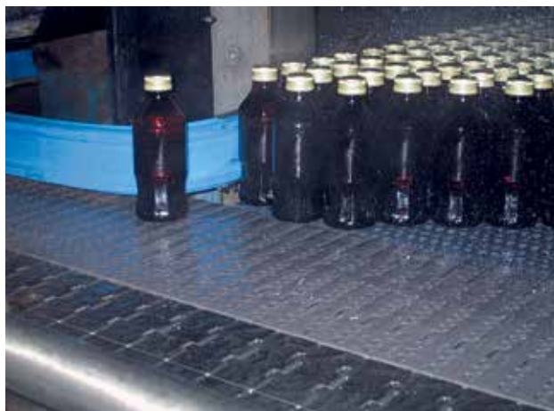
Transfert de bouteilles avec le tapis 7705
