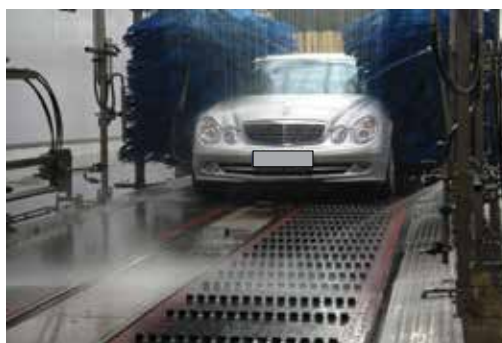
Tunnel de lavage double piste avec le tapis la série 6990 équipé de tasseaux t2
