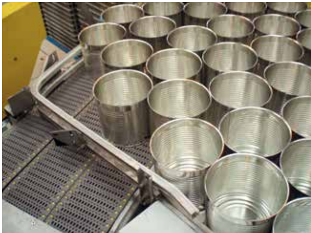
Canettes vides de 3 pièces sur HP8506 K450 MTW
